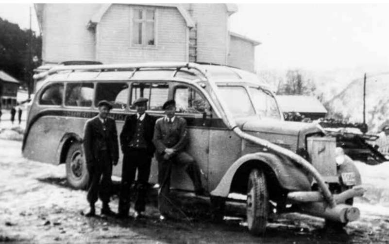
Knottgeneratorane var store, arbeidskrevjande og ikkje veldig effektive. Her ser vi T-1304 Reo frå Valldal–Åndalsnes Rutebilloag som trafikkerte ruta Dombås – Åndalsnes i krigsåra og var ganske identisk med Reoen som Olav Overå køyrde Stranda – Ålesund. Foto: Ivar Hoel. Utlånt av Rutebillohistorisk foreining.
